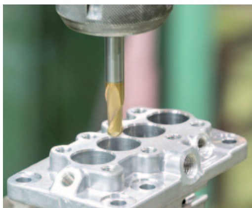
Perçage de centrage sur alliages légers au silicium, série 4000 (aluminiums de fonderie)
